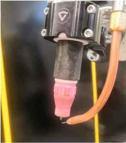
TIG-hitsauspolttimen kuvia, joissa näkyy myös kylmälangan syöttäminen.
